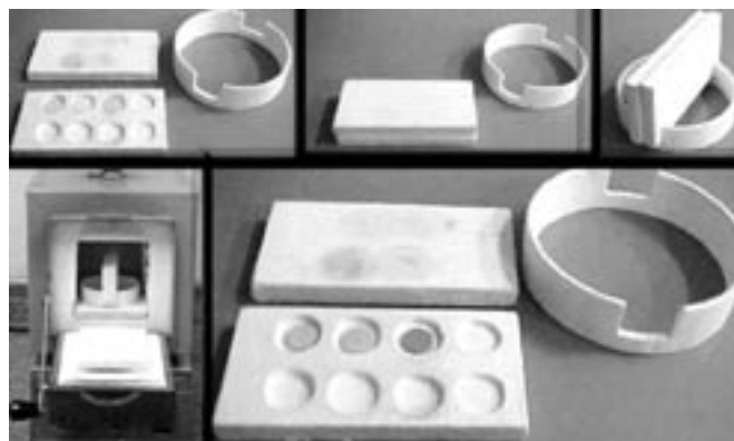
Fig. 1. Secuencia del proceso de sinterización con el nuevo dispositivo desarrollado.
